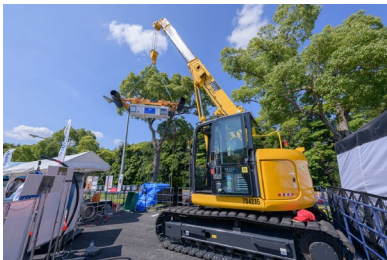
巻上ワイヤ破断防止装置付 クローラークレーン
